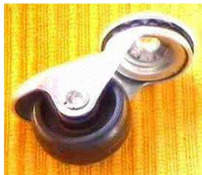
Supone el tercer punto de apoyo de la plataforma, gira libremente respecto a un eje vertical, para permitir su correcta orientación.
