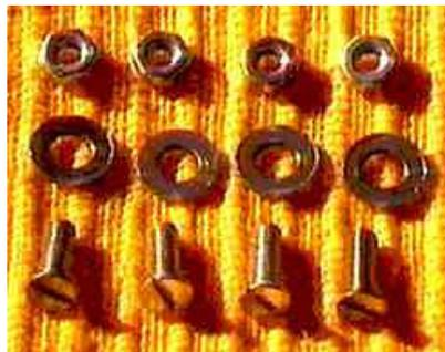
Cuatro tornillos con sus respectivas arandelas y tuercas permiten fijar las cajas reductoras (donde van acoplados los motores) a la base.
