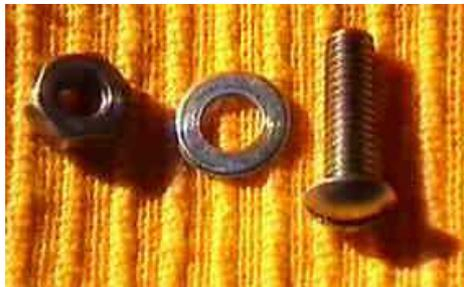
Tornillo de 5 mm de diámetro, con arandela y tuerca, que permite la fijación de la rueda loca a la base.
