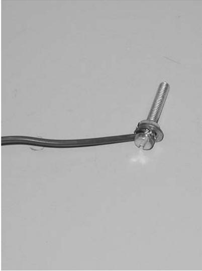
*Detalle del puntero metálico. Se trata de un tornillo con una tuerca y una arandela conectados al cable.*
