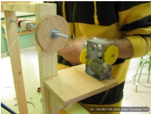
Detalle del puente izado. Es necesario colocar peso bajo el puente para que al bajar actúe sobre el final de carrera de bajada.
